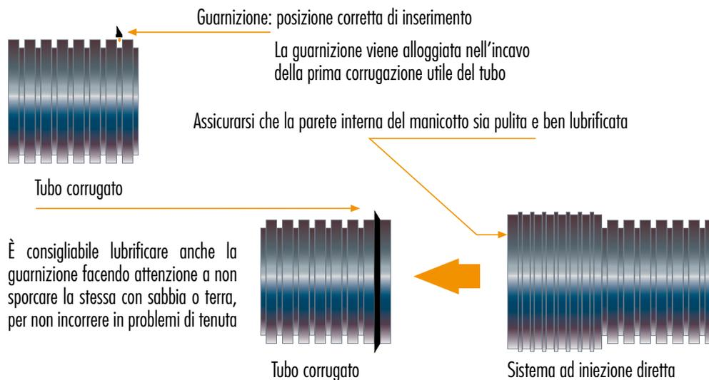
L'innesto deve essere eseguito con procedure che permettano una spinta costante ed uniforme. Si consiglia l'utilizzo di mezzi meccanici. Per un preciso inserimento si raccomanda di riportare sul tubo, tramite un segno, la lunghezza che intercorre tra l'ingresso del manicotto e la battuta, togliendo 1 cm circa. Esempio: lunghezza ingresso/battuta = 10 cm, riportare sul tubo 9 cm.
